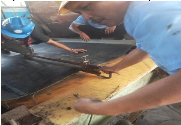
Gambar 7. Pengepresan Sambungan Belt
