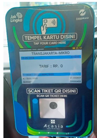
Gambar 1.2 Mesin EDC Acasia yang dibuat oleh PT Aino Indonesia
