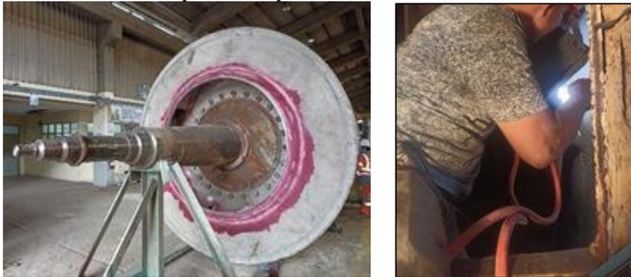
**Gambar 4.** Blade Impeller dan Proses Penambahan Massa
