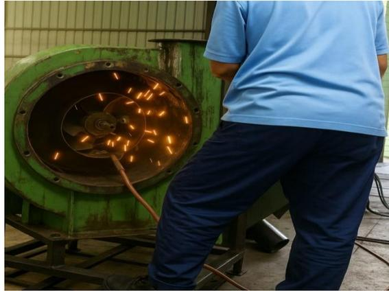
**Gambar 5.** Perbaikan balancing pada impeller
