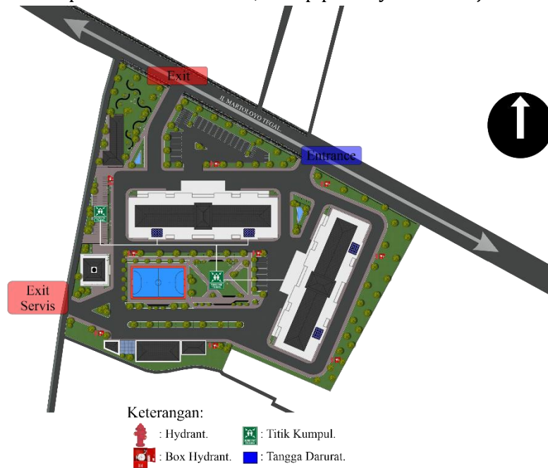
Gambar 1.15 Peletakan Titik Hydrant
