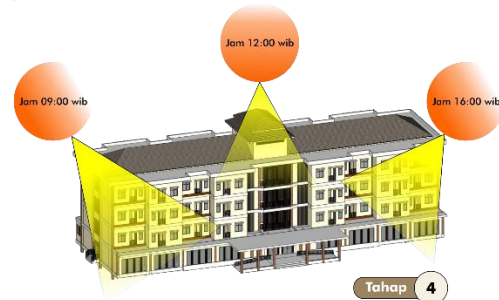
Tahap 4 Tahap empat pada finish gubahan yang menjadikan gubahan memiliki karakteristik pada bangunan rusunawa, serta memberikan fungsi pada pengguna nantinya yang berangkat dari prinsip arsitektur tropis, seperti ventilasi silang, bukaan, dan isolasi panas matahari.
