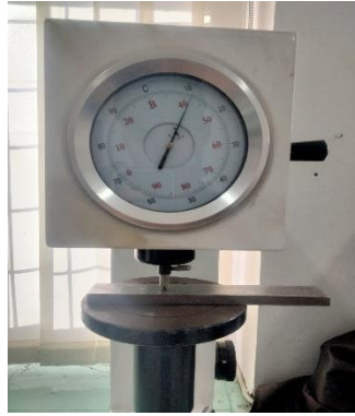
Gambar 3.1 Uji Kekerasan Awal Baja SKD-11
