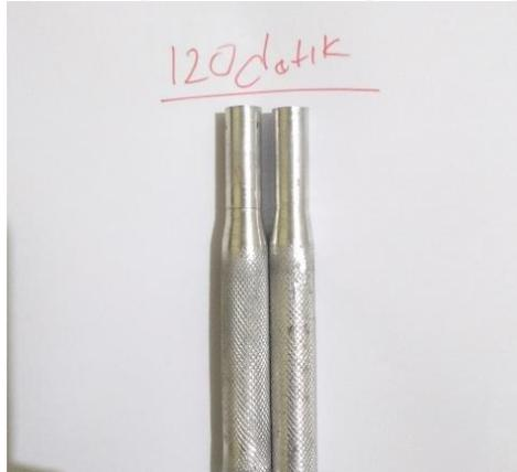
Gambar 5. Hasil uji tarik dengan variasi waktu 120 detik
