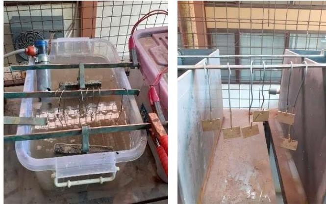
Gambar 5. Proses elektroplating keenam spesimen
