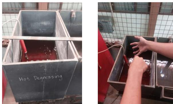
Gambar 2. Benda kerja direndam pada proses hot degreasing
