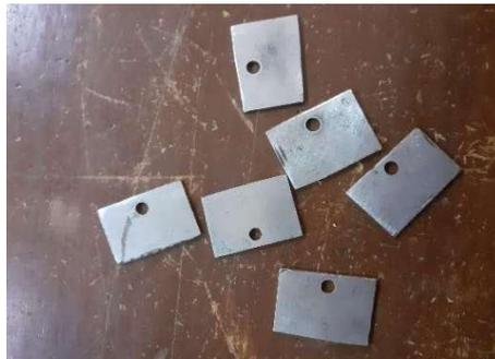
Gambar 1. Spesimen plat baja AISI 1020
