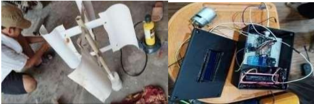
(a) (b) Gambar 4. a Pembuatan baling baling kincir angin, b perancangan komponen mikrokontroler Pengetesan kincir angin
