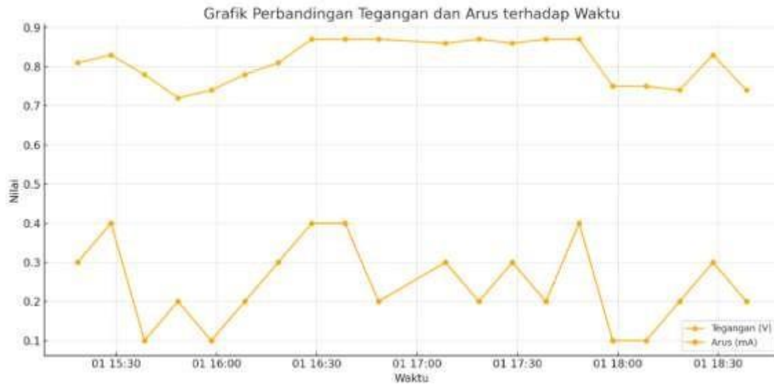
Gambar 9. Grafik perbandingan hasil ukur arus dan tegangan.
