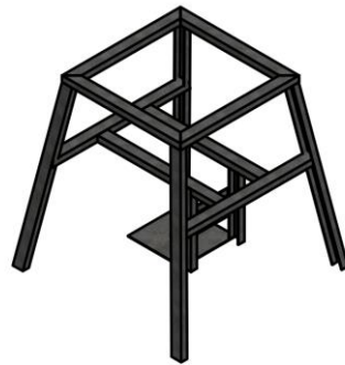
Gambar 2. Desain Rangka Mesin Penghalus Arang Tempurung Kelapa Sumber: Autodesk Inventor Student 2024
