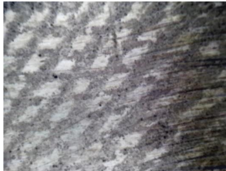
Gambar 6. Hasil Uji Mikrostruktur Tanpa Perlakuan Apapun
