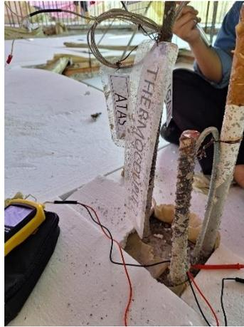
Gambar 4. Titik Thermocouple Yang Telah Terpasang
