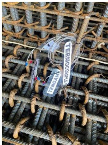
Gambar 4. Titik thermocouple Yang Telah Terpasang
