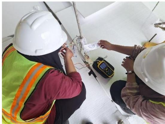
Gambar 5. Pembacaan Monitoring Suhu Beton
