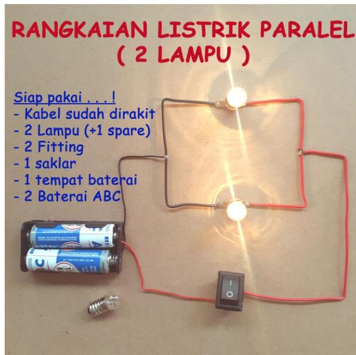
Gambar 2. Praktikum Sederhana Penerapan Rangkaian Paralel.
