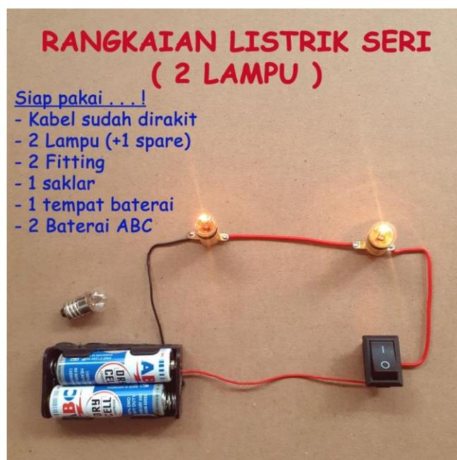
Gambar 1. Praktikum Sederhana Penerapan Rangkaian Seril.
