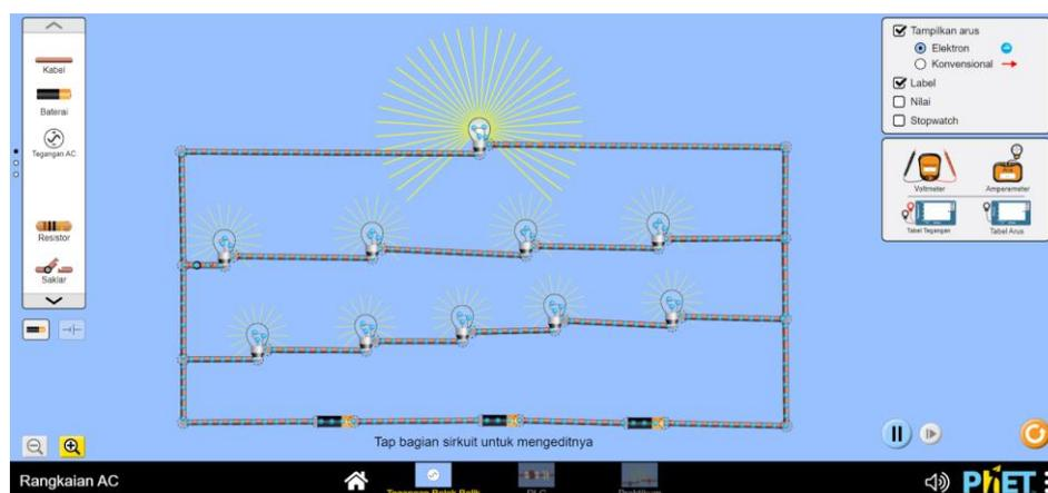
Gambar 3. Aplikasi PHET Pada Rangkaian Seri dan Rangkaian Paralel.
