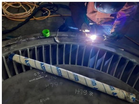
**Gambar 7.** Proses Perbaikan Diaphragm Di Pihak Ke-3 1
