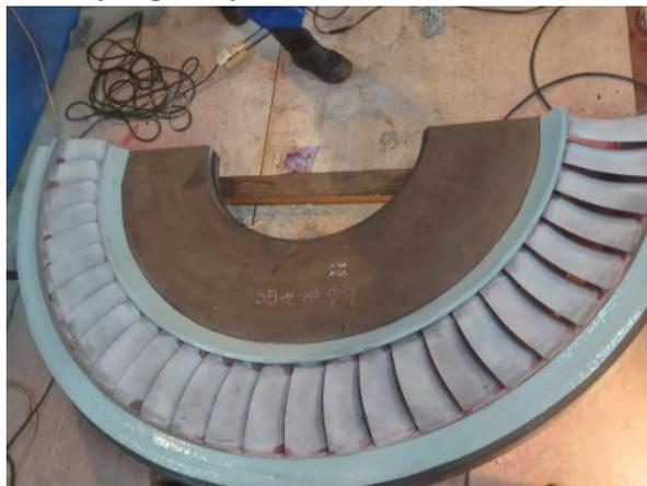
**Gambar 4.** Kegiatan Perbaikan dengan Memakai Metode Ceramic Coating 1
